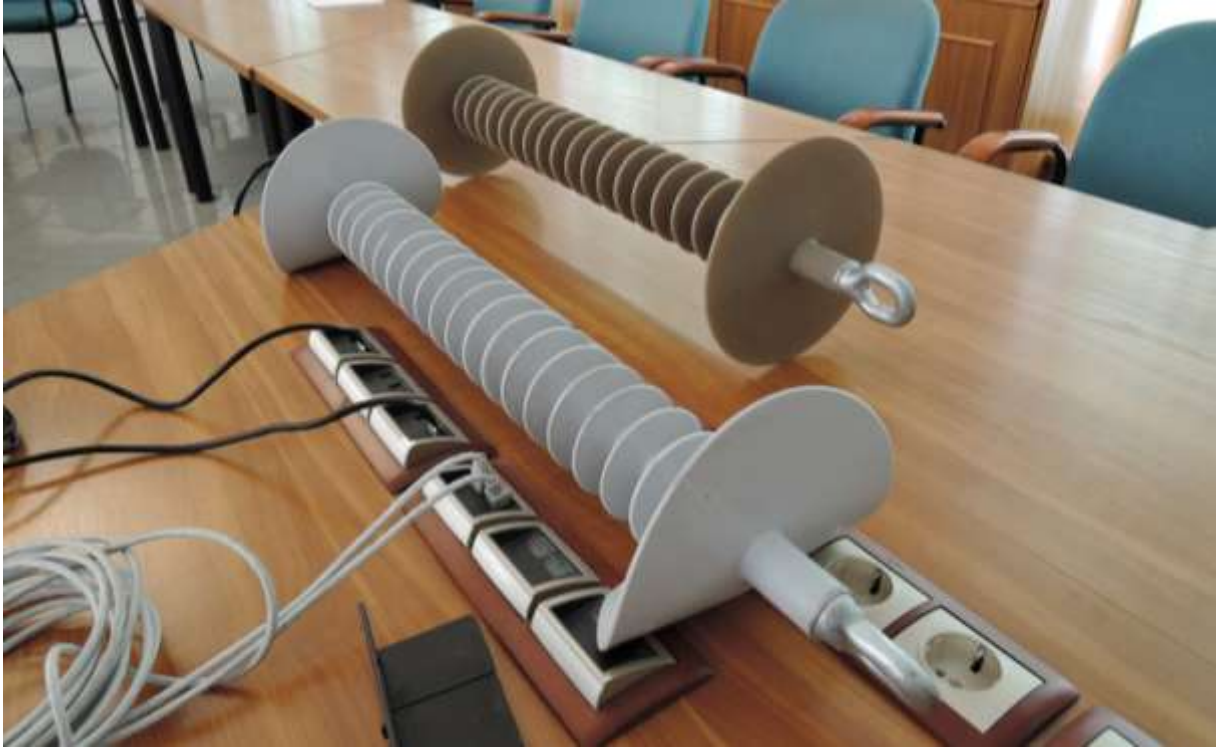
5. kép: Az NKM Áramhálózati Kft. szegedi székházában 2019. júniusában bemutatott 800mm hosszú feszítőszigetelő (a szürke szilikon bevonatú, míg a barna színű egy műgyanta bevonatú változat)
