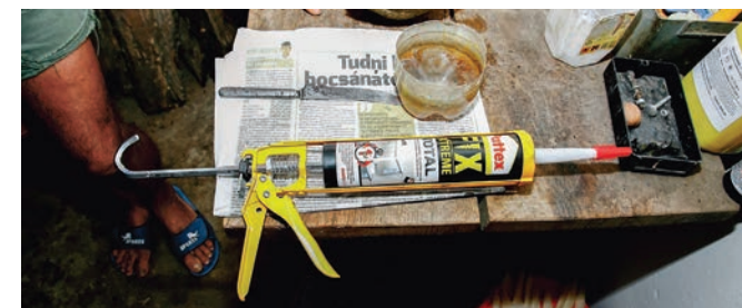
A tubusból a pisztoly segítségével nyomjunk ki 15–20 cm hosszúságú, ujjnyi vastag ragasztóanyagcsíkot,...
