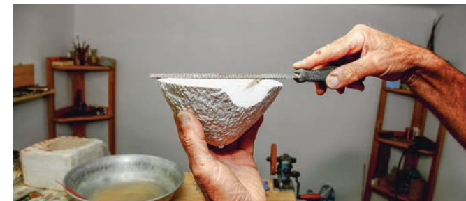
Néhány napnyi teljes száradás után smirgivel csiszoljuk simára a fészkek belsejét, ráspollyal reszeljük vízszintesre a felső peremrészeket (ez a kihelyezésnél lesz majd fontos),...
