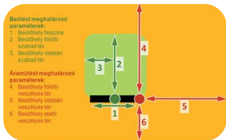
13. ábra: Madarak beüléséhez szükséges (zöld), illetve az áramutés szempontjából veszélyes (narancs) területek elhelyezkedése egy potenciális beülőhely körül (Ábra: Horváth Márton).
